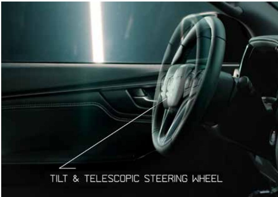
Regulación volante en altura y profundidad
